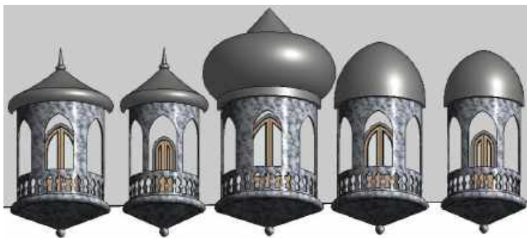
Рисунок 7 – Эркеры, созданные на основе одного семейства
